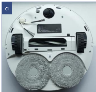
Шаңсорғышты түбін төңкеріп, жоғары қарата қойыңыз.
