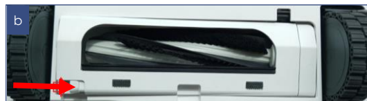
Электр щетканың білік қақпағын қақпақтың сол жағындағы бекіткіш түймесін басу арқылы шешіп алыңыз
