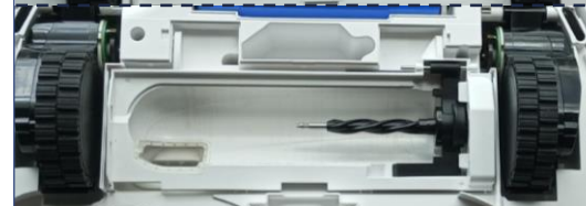
Щетка білігін солға қарай жылжытып, оны тіреуімен (оң жақтағы) суппортпен бірге жоғары көтеріңіз.
