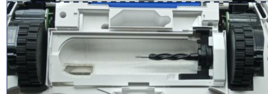
Переместите валик щетки влево и поднимите его вверх вместе с суппортом (справа).
