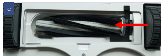
Электр щетканың білік қақпағын қақпақтың сол жағындағы бекіткіш түймесін басу арқылы шешіп алыңыз
