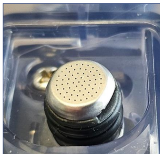
Металлический фильтр с микроотверстиями (крупным планом)
