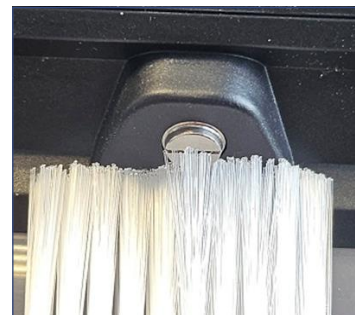
Әк шөгінділерін жұмсақ щеткемен кетіріңіз.(қосылмаған)
