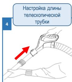
Сдвиньте вперед (от себя) пластиковый фиксатор и вытяните ее, отрегулировав до нужной длины
