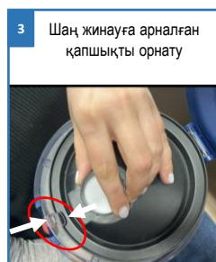
Шаң қапшықтың жақтауындағы ойықты корпуспен туралаңыз
