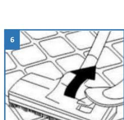
Для использования щетки для жёстких покрытий – нажмите на рычаг на насадке
