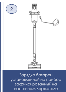
Зарядка батареи установленной на прибор
