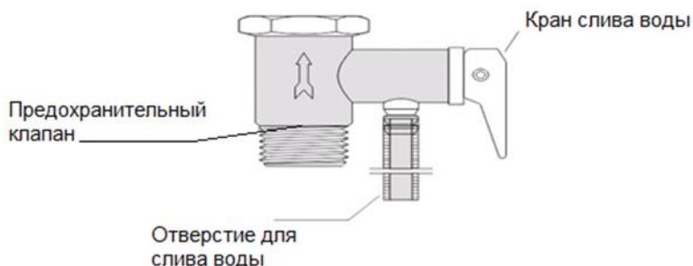
Запобіжний клапан виконує дві функції:
