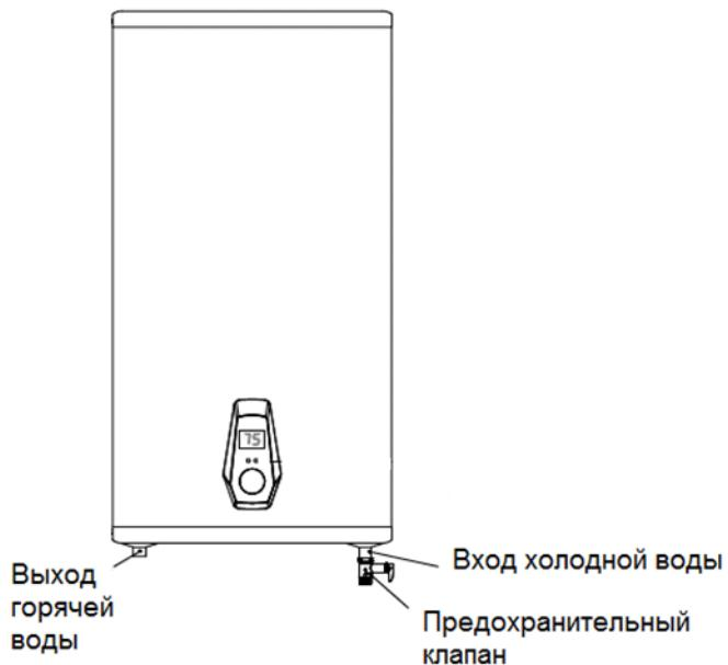
**Неправильний вибір патрубків для відведення / відведення води та помилкове підключення спричиняє порушення нормальної роботи водонагрівача, призводить до виходу його з ладу та може завдати шкоди здоров'ю та майну користувача!**
