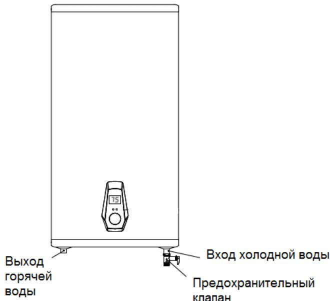
**Неправильный выбор патрубков для подвода / отвода воды и ошибочное подключение вызывает нарушение нормальной работы водонагревателя, приводит к выходу его из строя, и может причинить ущерб здоровью и имуществу пользователя!**
