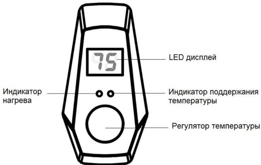
При досягненні заданої температури вбудований термостат автоматично вимикає нагрівальний елемент та індикатор гасне. Тепер водонагрівач перебуває в режимі підтримання температури.
