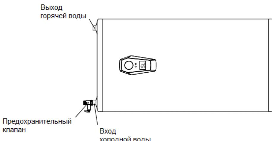
2. При вертикальном варианте установки аппарата подвод холодной воды осуществляется к **ПРАВОМУ** патрубку водонагревателя, и предохранительный клапан устанавливается на
