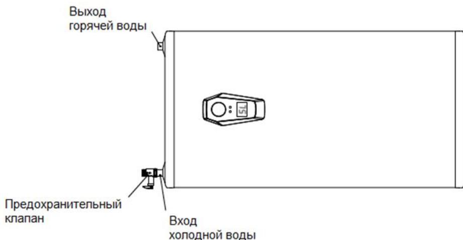
2. При вертикальному варіанті встановлення апарату підведення холodnoї води здійснюється до **ПРАВОГО** патрубка водонагрівача, і запобіжний клапан встановлюється на цей **ПРАВИЙ** патрубок. У цьому випадку відведення нагрітої води до споживачів здійснюється через **ЛІВИЙ** патрубок (див. малюнок нижче).
