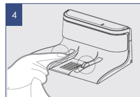
Зарядтау базасындағы байланыс клеммаларын тазалау
