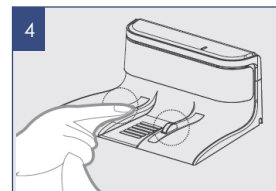
Очистка контактных клемм на зарядной базе
