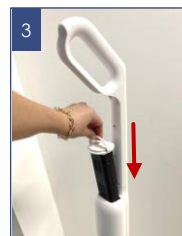
Установите аккумуляторную батарею в слот для батареи
