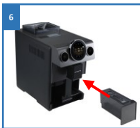
Су резервуарын құрылғы корпусына қайта орнатыңыз
