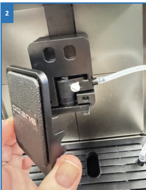
Крышка на магнитах – легко снимается! Не прикладывайте чрезмерных усилий!
