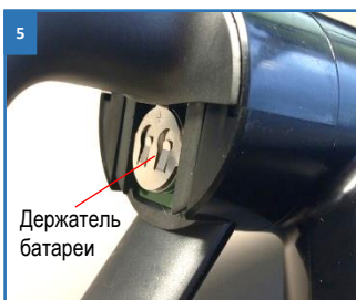
Сдвиньте батарею вниз из держателя и снимите ее
