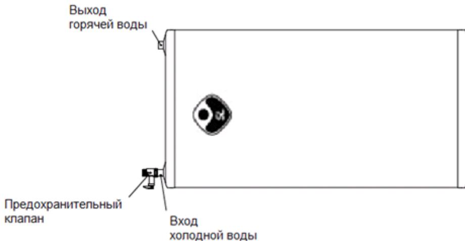
2. При вертикальном варианте установки аппарата подвод холодной воды осуществляется к ПРАВОМУ патрубку водонагревателя, и предохранительный клапан устанавливается на этот ПРАВЫЙ патрубок. В этом случае отвод нагретой воды к потребителям осуществляется через ЛЕВЫЙ патрубок (см. рисунок ниже).
