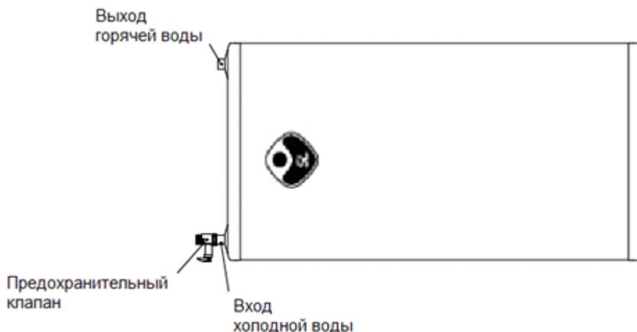
2. При вертикальному варіанті встановлення апарату підведення холодної води здійснюється до **ПРАВОГО** патрубка водонагрівача, і запобіжний клапан встановлюється на цей **ПРАВИЙ** патрубок. У цьому випадку відведення нагрітої води до споживачів здійснюється через **ЛВІЙ** патрубок (див. малюнок нижче).
