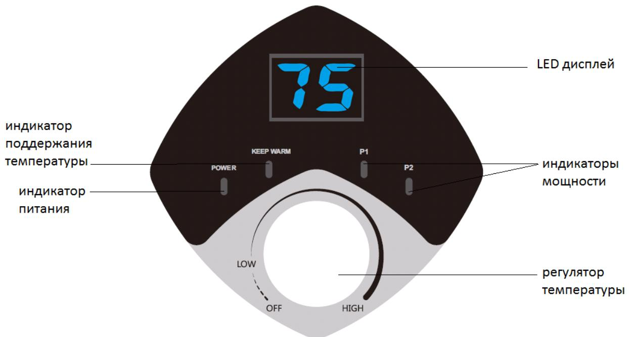
При достижении заданной температуры встроенный термостат автоматически отключает нагревательный элемент. Теперь водонагреватель находится в режиме поддержания температуры. Загорается индикатор поддержания температуры KEEP WARM.
