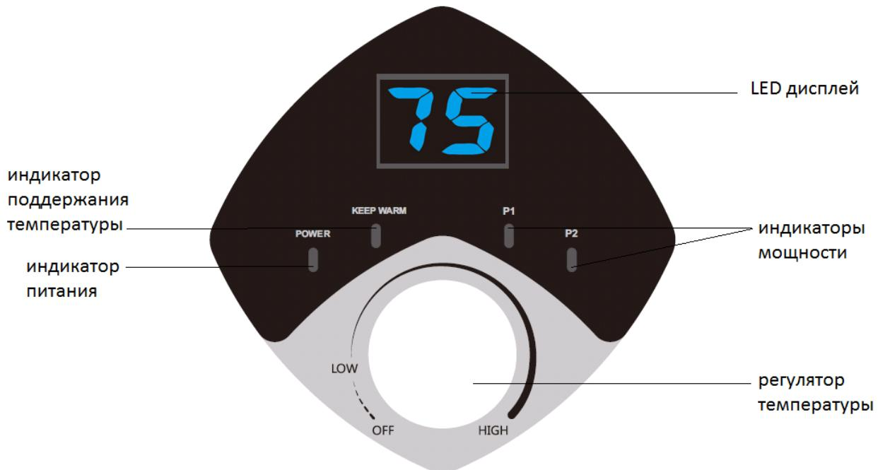
При досягненні заданої температури вбудований термостат автоматично вимикає нагрівальний елемент. Тепер водонагрівач перебуває в режимі підтримання температури. Спалахує індикатор підтримання температури KEEP WARM.
