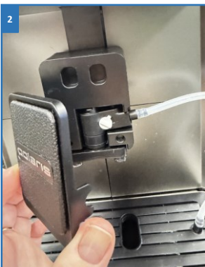
2 Крышка на магнитах – легко снимается! Не прикладывайте чрезмерных усилий!
