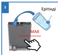
Суға арналған резервуарға кальцийсіздендіруге арналған құралды сумен араластырып құйыңыз
