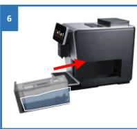
Су резервуарын құрылғы корпусына қайта орнатыңыз
