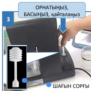
Су резервуарының қабылдағыш торапына шағын сорғының түтігін кіргізіп, піспекке басыңыз
