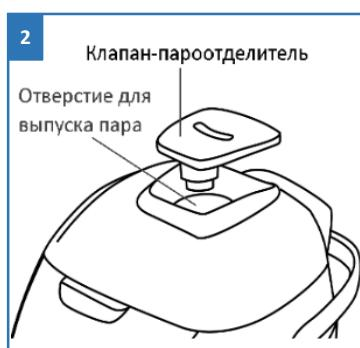
Клапан-пароотделитель имеет съемную конструкцию, регулярно промывайте его водой во избежание засорения
