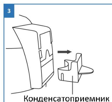
После каждого приготовления необходимо снять и опустошить конденсатоприемник.
