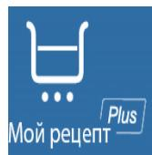
В данной модели мультиварки реализована многоэтапная программа ручной настройки «Мой Рецепт Plus», которая запускается из режима ожидания одноименным сенсором и позволяет устанавливать различную температуру на девяти последовательных этапах приготовления, а также устанавливать длительность каждого этапа при суммарном времени работы до 9 часов 55 минут. Индикация этапа приготовления расположена в правом верхнем углу дисплея.
